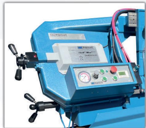
Tensor de hoja con luz testigo y medida de seguridad ante corte o tensión incorrecta de la cinta.
