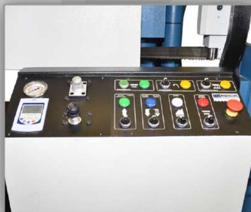
● Tablero electrónico con regulador de cortes.
