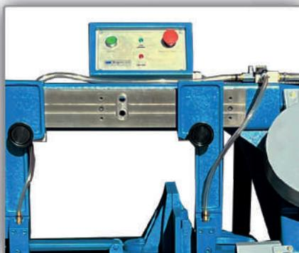
Comando de tablero y sistema coliza para mayor precisión de cortes.
