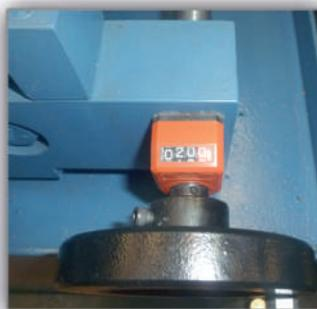
Sensor de altura del corte.
