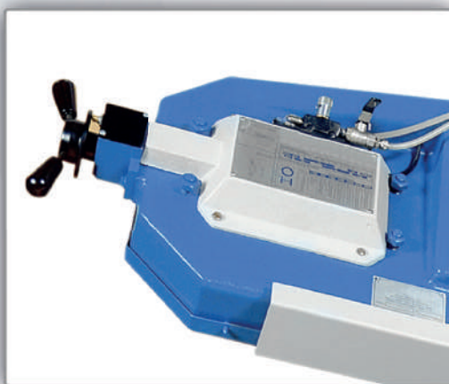
Tensor de hoja con medida de seguridad ante corte o tensión incorrecta de la cinta.
